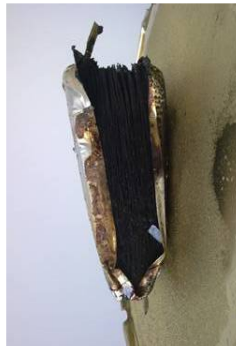
常规隔膜：未通过穿钉测试
